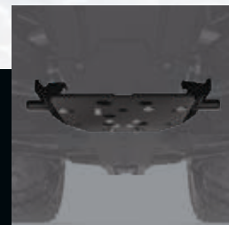
La placa de montaje de perfil bajo tiene un menor impacto en la altura del chasis al suelo y se puede dejar instalada todo el año.
