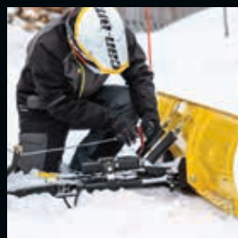
Enganche el cable del cabrestante a la pala con ayuda de un rodillo o gancho guía.
