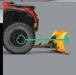
La placa de montaje en los bajos ofrece un óptimo ángulo de ataque para la máxima fuerza de empuje.
