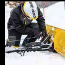
Engancha el cable del cabrestante a la pala con ayuda de un rodillo/gancho guía.
